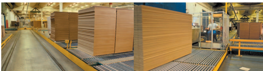
Fig. 536 Når skiftvogner transporterer bølgepappen går alt på skinner.
