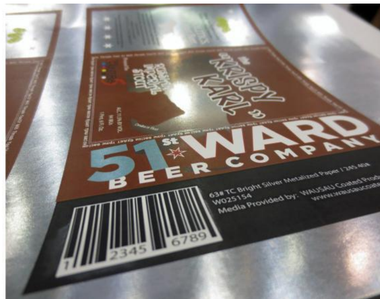
Hvit digitalfarge på metallisert folie/aluminium
