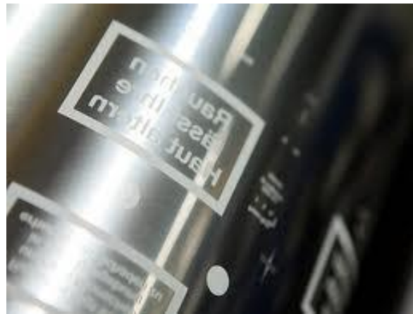
Trykkbildet ligger som celler gravert inn i overflaten på trykksylinderen
