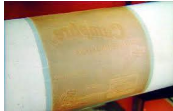
Klisje montert på plate Som monteres i maskinen (bølgepapp)
